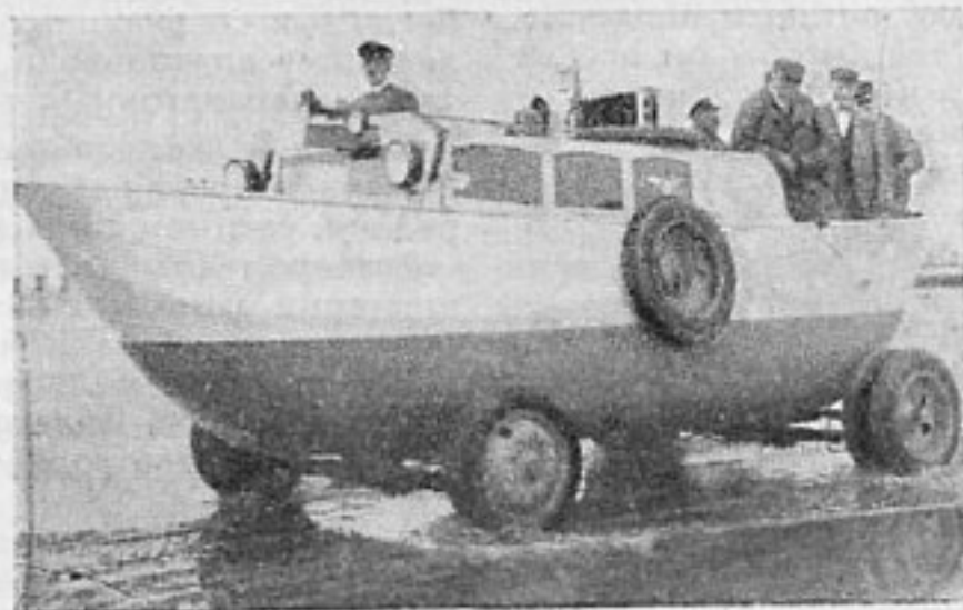
По суше и по воде. Новый тип автомобиля, способный передвигаться по суше и по воде, недавно сконструированный в Америке
